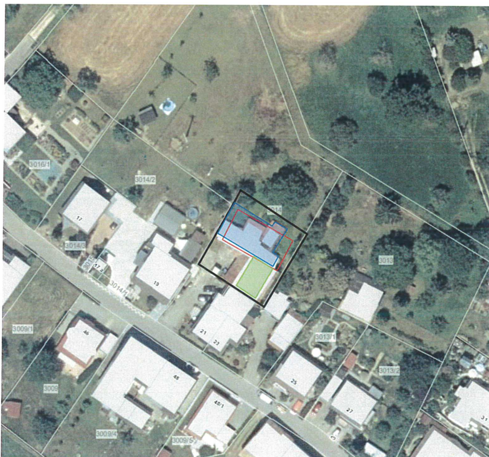
Abbildung 1: Luftbildübersicht des Planbereichs mit den Baugrenzen für den Neubau (rot) und der Grenze des räumlichen Geltungsbereichs der Einbeziehungssatzung (§ 9 Abs. 7 BauGB) (schwarz). Dieser Bereich entspricht dem Untersuchungsgebiet. Tatsächliche Abrissgebäude blau hinterlegt. Im grün hinterlegten Bereich erfolgt keine Veränderung.
